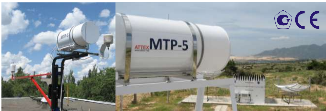
Примеры измерительной системы на основе МТР-5. Нововоронеж с лета 2012 (слева) и температурный профилемер во Вьетнаме (Ниньтхуан 1) с лета 2013 (справа).
